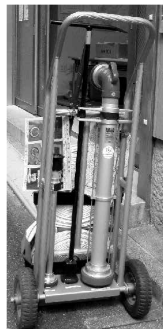
写真：スタンドパイプ、ホース等一式
