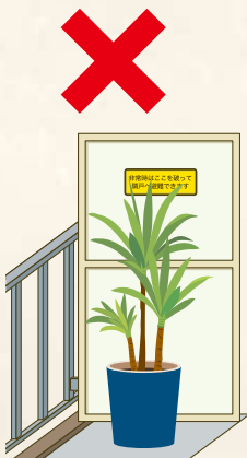
隔て板(蹴破り戸) 付近への設置
