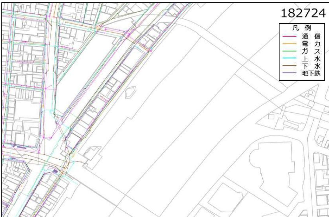
図：地下埋設物の状況図
